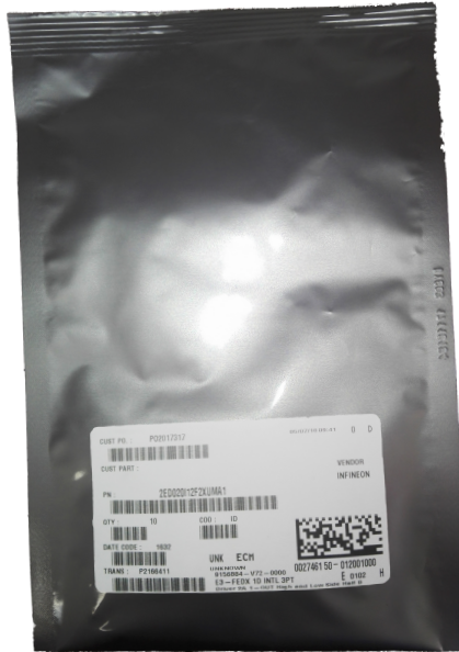
Figura 2.22. Drivers 2ED020I12-F2 dentro de bolsa anti-estática de nivel 3 de seguridad
