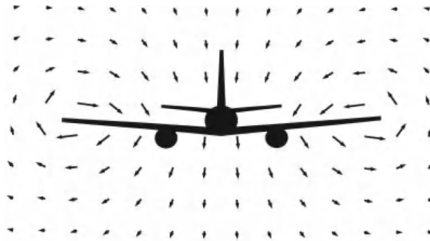
Figura 3.8: Campo de velocidad alrededor de una aeronave, vista de un plano yz [62].
