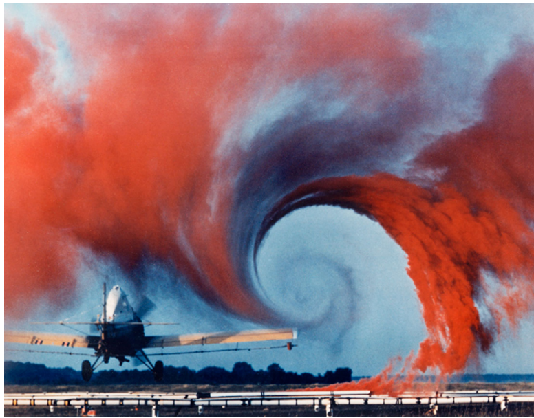
Figura 2.1: Vórtice generado en la punta de un ala (NASA).
