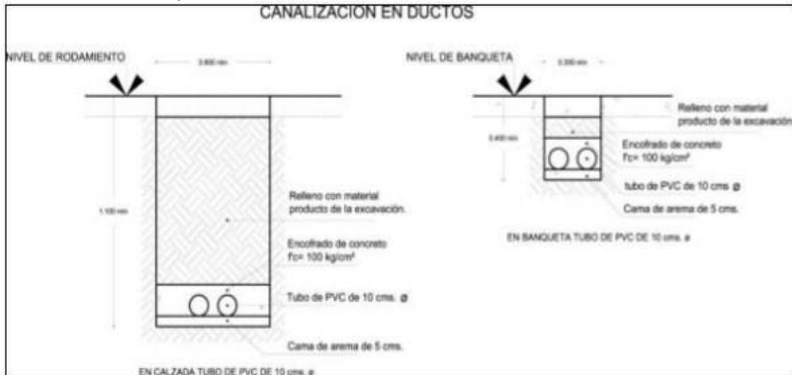
Imagen 76 Planos para trabajos de canalización a Acometida Eléctrica.
