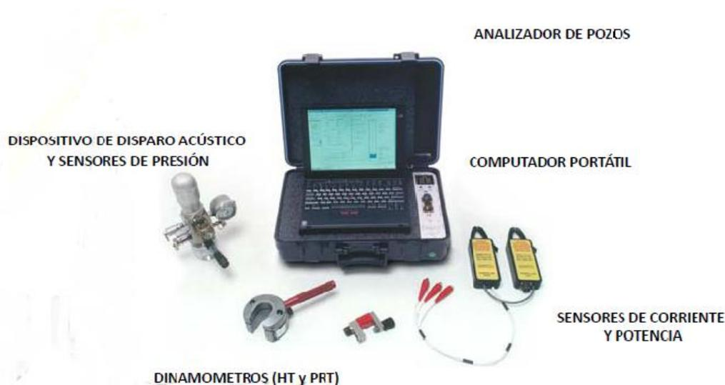
Fig. 3.7.3.1. Equipos de Medición Echometer<sup>8</sup>.
