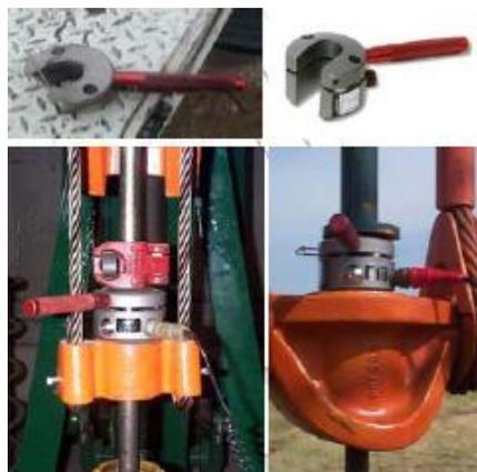
Fig. 3.7.3.5. Transductor Tipo Herradura “HT”. Este transductor debe posicionarse entre la grampa y el elevador.
