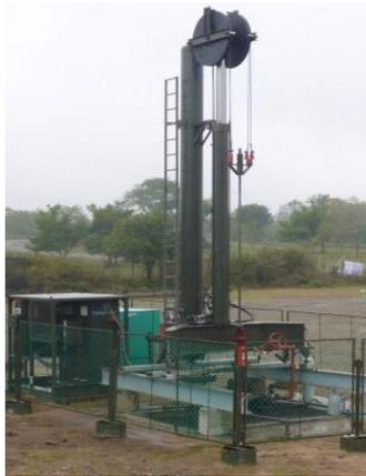
Fig. 2.2. Unidad de Bombeo Mecánico no convencional.
