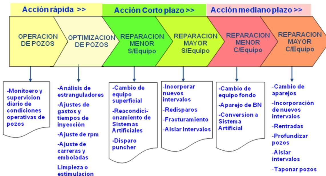
Fig. 3.7.1. Esquema de las diferentes intervenciones a las que puede ser programado un pozo dentro del Grupo de Productividad de Pozos.
