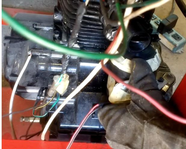
**Figura 3.10:** Prueba preliminar del funcionamiento del inyector ultrasónico conectado al colector de admisión junto con la válvula mariposa.
