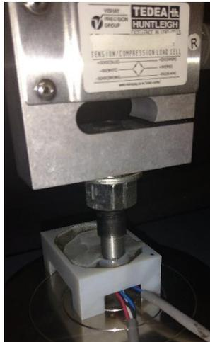
Figura 45. Fotografía deformación de la membrana en la prueba a compresión.
