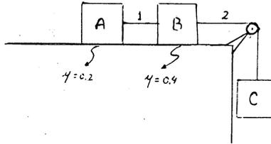
$\mu$  = coeficiente de fricción entre el plano y los cuerpos.
