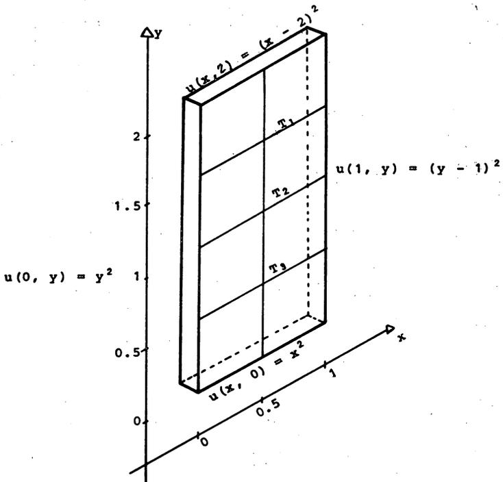
La temperatura en el centro de la placa, debe mantenerse entre cero y un grado centígrado para asegurar el buen funcionamiento de la máquina, las temperaturas en la periferia de dicha placa varían en las cuatro caras debido a la estructura de la propia máquina.
