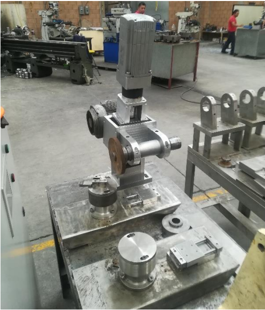
Figura 19. Colocación de base de disco para afilado
