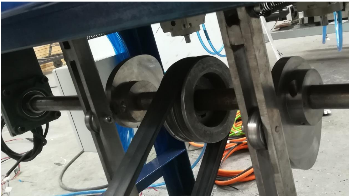
Figura 25. Colocación de levas en maquina afiladora.
