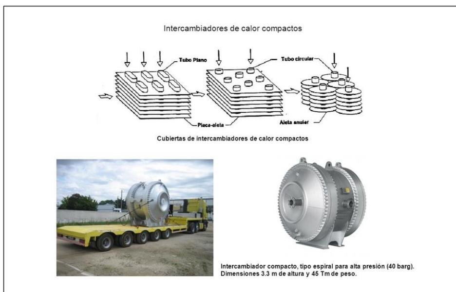
*Figura 4. Intercambiador de calor compacto.*
