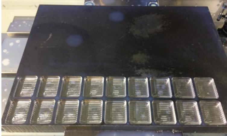
Figura 16. Maquinado final de 9 experimentos con 1 réplica (Ortega & Soladana. 2018).
