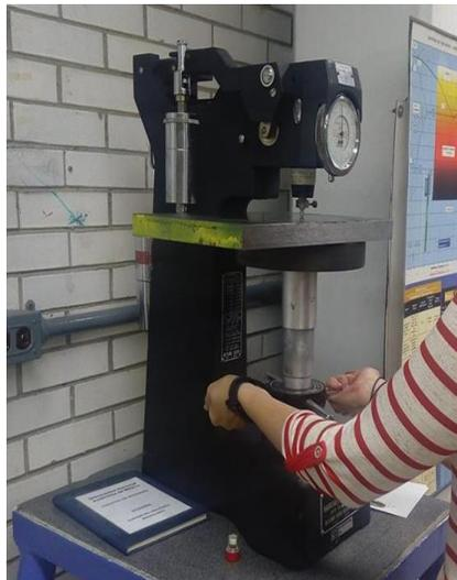
Figura 8. Calibración de durómetro (Ortega & Soladana. 2018).
