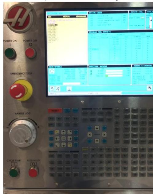
Figura 11. Paso 3-g: máquina encendida (Ortega & Soladana. 2018).
