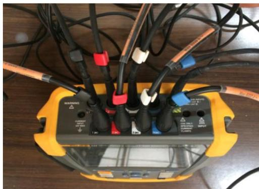
Figura 5. Paso 1-f: conexión BNC (Ortega & Soladana. 2018).
