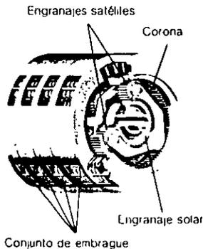
Servotransmisión planetaria, diseñada para trabajo duro... con grandes conjuntos de embragues que rodean los juegos de engranajes planetarios. La modulación hidráulica amortigua la conexión de los embragues en los cambios sobre la marcha. Los engranajes planetarios, espaciados a 120°, distribuyen las cargas torsionales para más duración. El enfriamiento con aceite y la lubricación reducen el calor y el desgaste por fricción.
