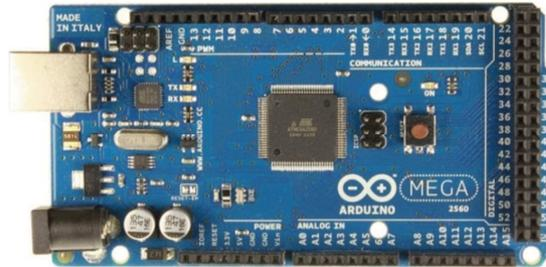
Ilustración 3.4 Placa Arduino Mega 2560, fuente [www.arduino.cc/es](http://www.arduino.cc/es)
