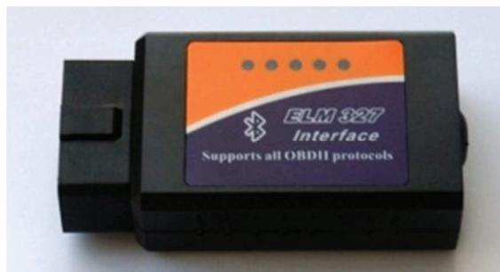
Ilustración 3.2 Escáner ELM327, fuente [www.diagnosticoautomotor.com](http://www.diagnosticoautomotor.com)
