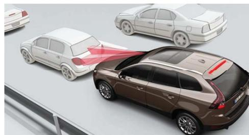
Ilustración 1.3 Sistema City Safety, fuente [www.volvocars.com/us](http://www.volvocars.com/us)
