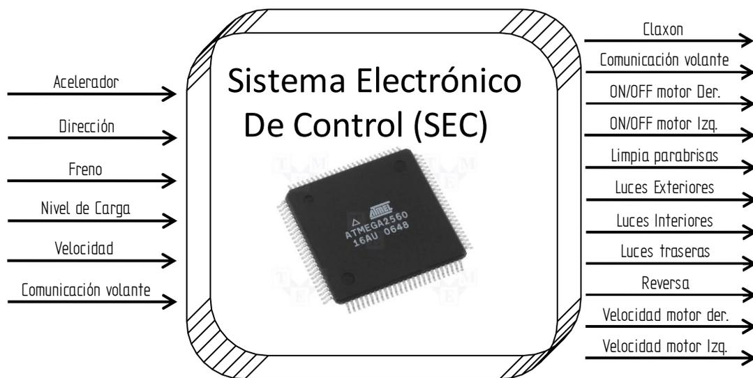
Figura 5.1: Diagrama de entradas y salidas.
