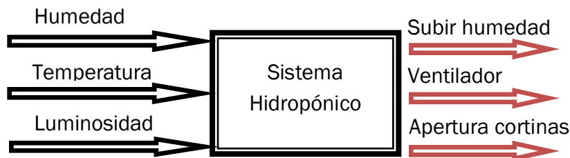
Figura 5.2: Diagrama de entradas y salidas para invernadero.
