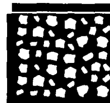
Recubrimiento con una delgada capa extendida en frío
