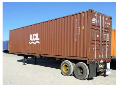
Fig. 3 Contenedor de 40´ equivale a 2 TEU.
