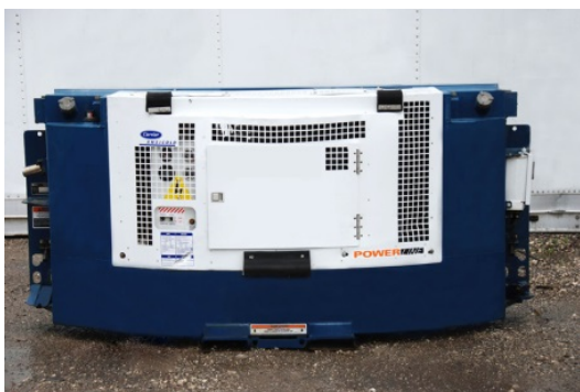
Fig. 7 Generador Clip-on , se sitúa en la parte frontal del reefer.
