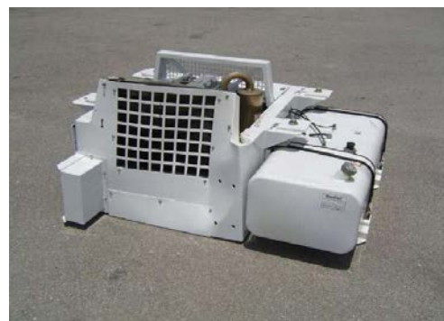
Fig. 8 Generador under. Se sitúa debajo del chasis.
