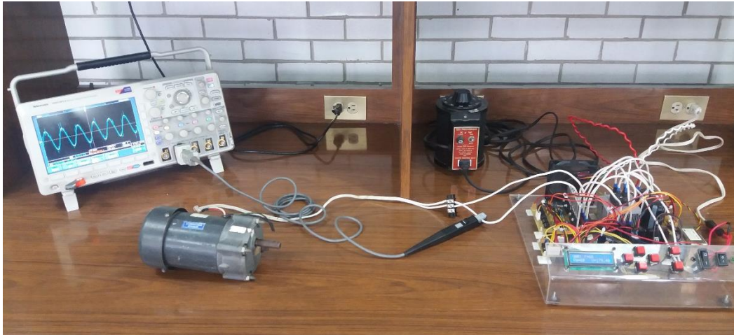
Figura 38. Conexión de tarjeta de prueba con la carga (motor de 127 [V rms ] y 60 [Hz]).
