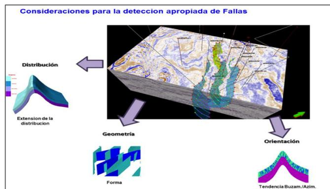
**Figura 38** . Consideraciones principales para detectar fallas y fracturas.
