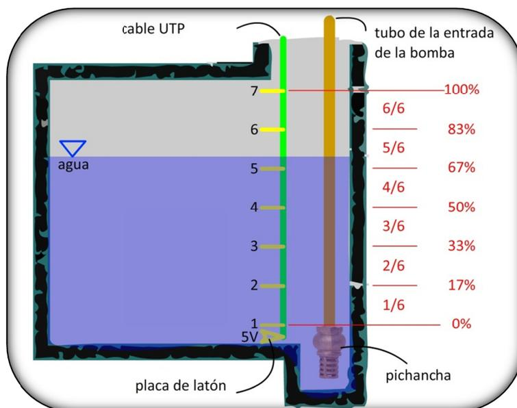
Ilustración 26: Posición de los electrodos en la cisterna.
