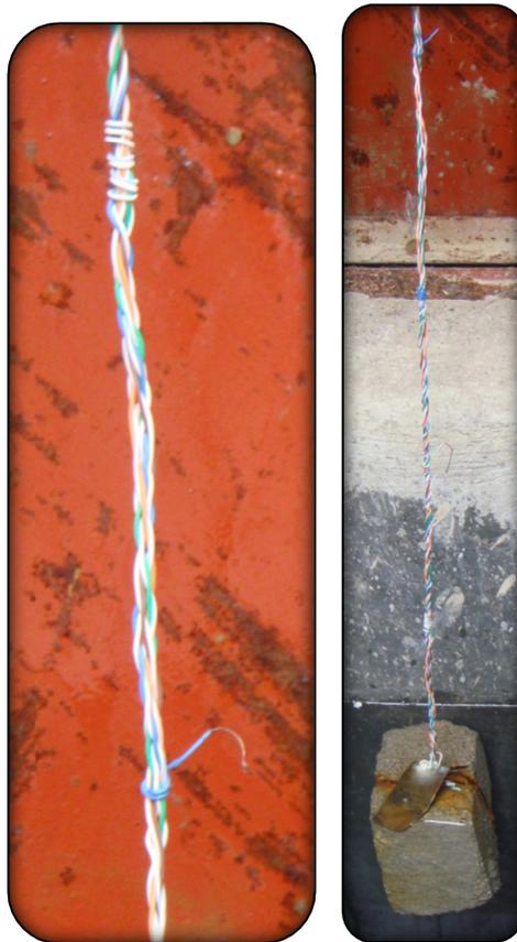
Ilustración 25: Sensores resistivos.
