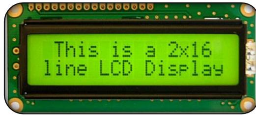
Ilustración 32: Pantalla LCD 16x2 con luz de fondo.
