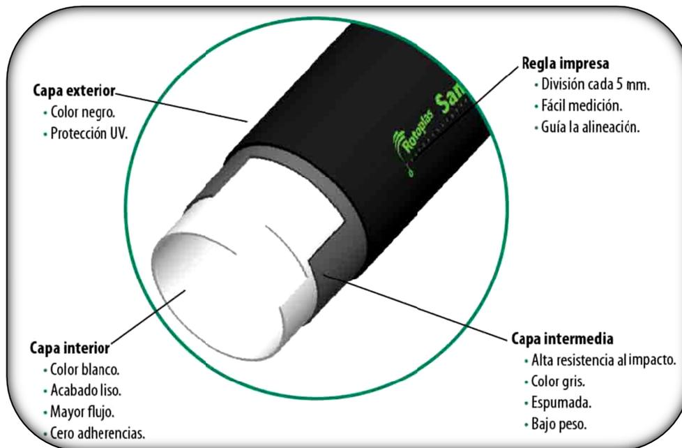
Ilustración 13: Capas de los elementos de tubería utilizados.
