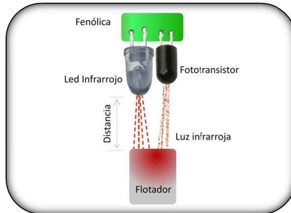
Ilustración 10: Posición del sensor y el flotador.
