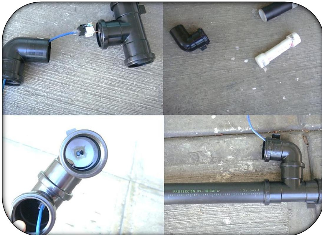
Ilustración 17: Sensor óptico construido.
