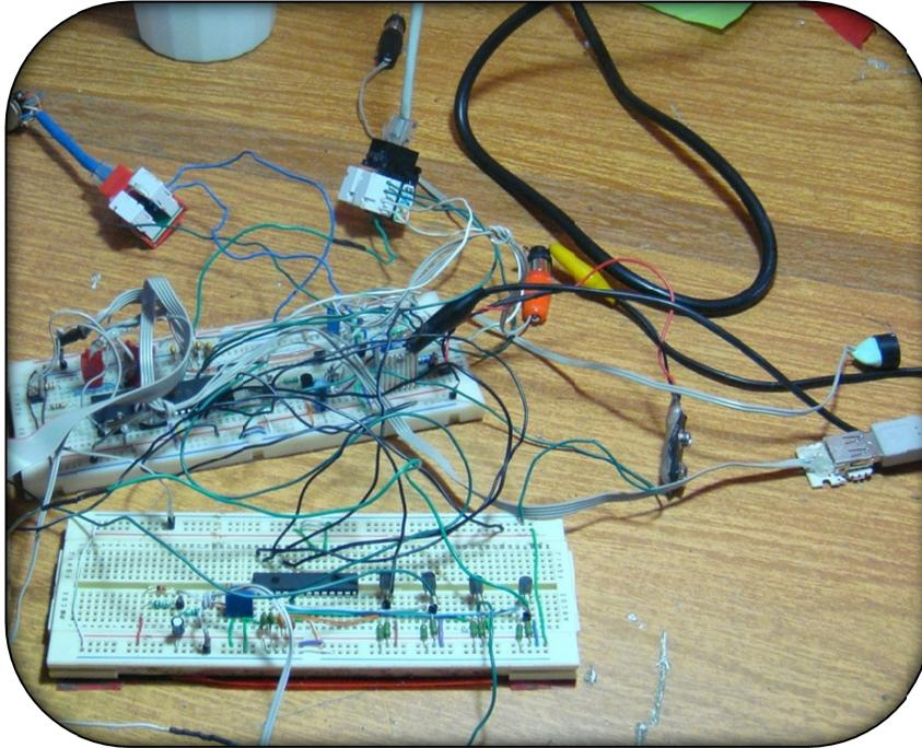
Ilustración 41: Circuito eléctrico del dispositivo, implementado en *protoboard*.
