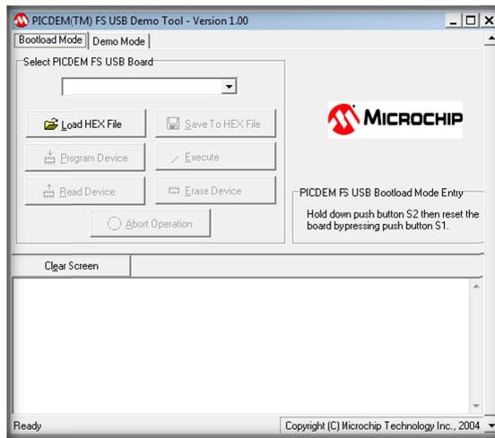
Ilustración 39: Software PICDEM(TM) FS USB Demo Tool – versión 1.00, utilizado para reprogramar el PIC.
