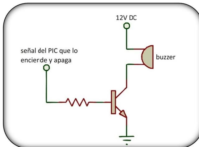
Ilustración 36: Circuito de conexión del buzzer.
