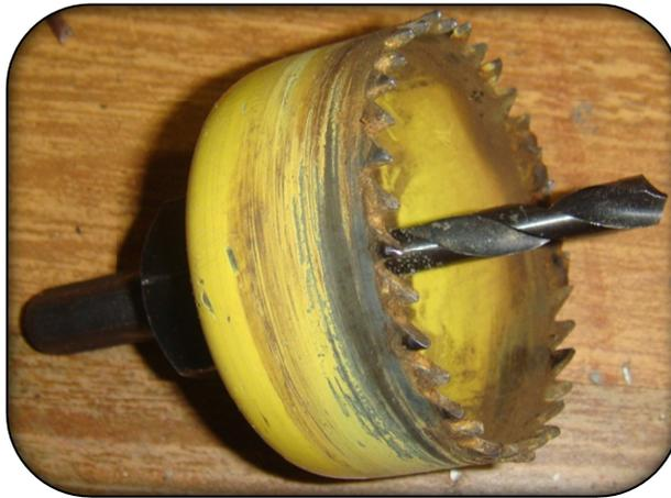
Ilustración 45: Herramienta para perforar la tapa del tinaco.
