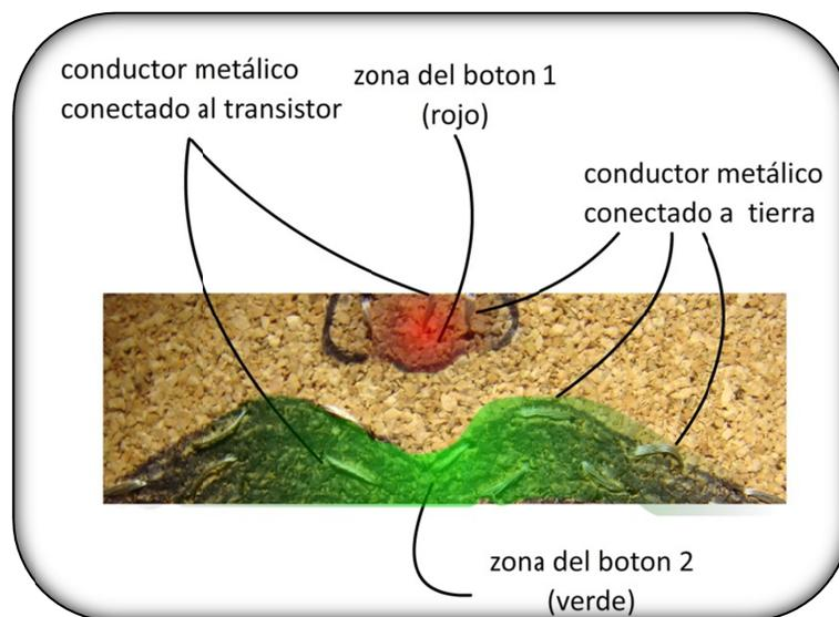
**Ilustración 34: Botones touch.** Los conductores están colocados muy cerca uno del otro; cuando el dedo toca la zona del botón, hace contacto con ambos conductores al mismo tiempo, mandando una señal clara.
