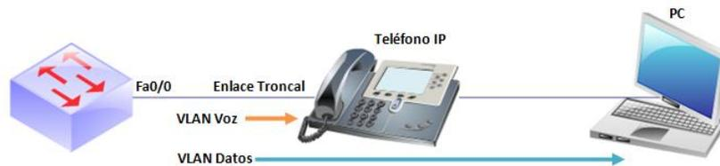
Figura 2.22 Uso de VLANs para separar el tráfico de voz y el tráfico de datos
