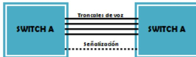
Figura 2.8 Señalización por canal común
