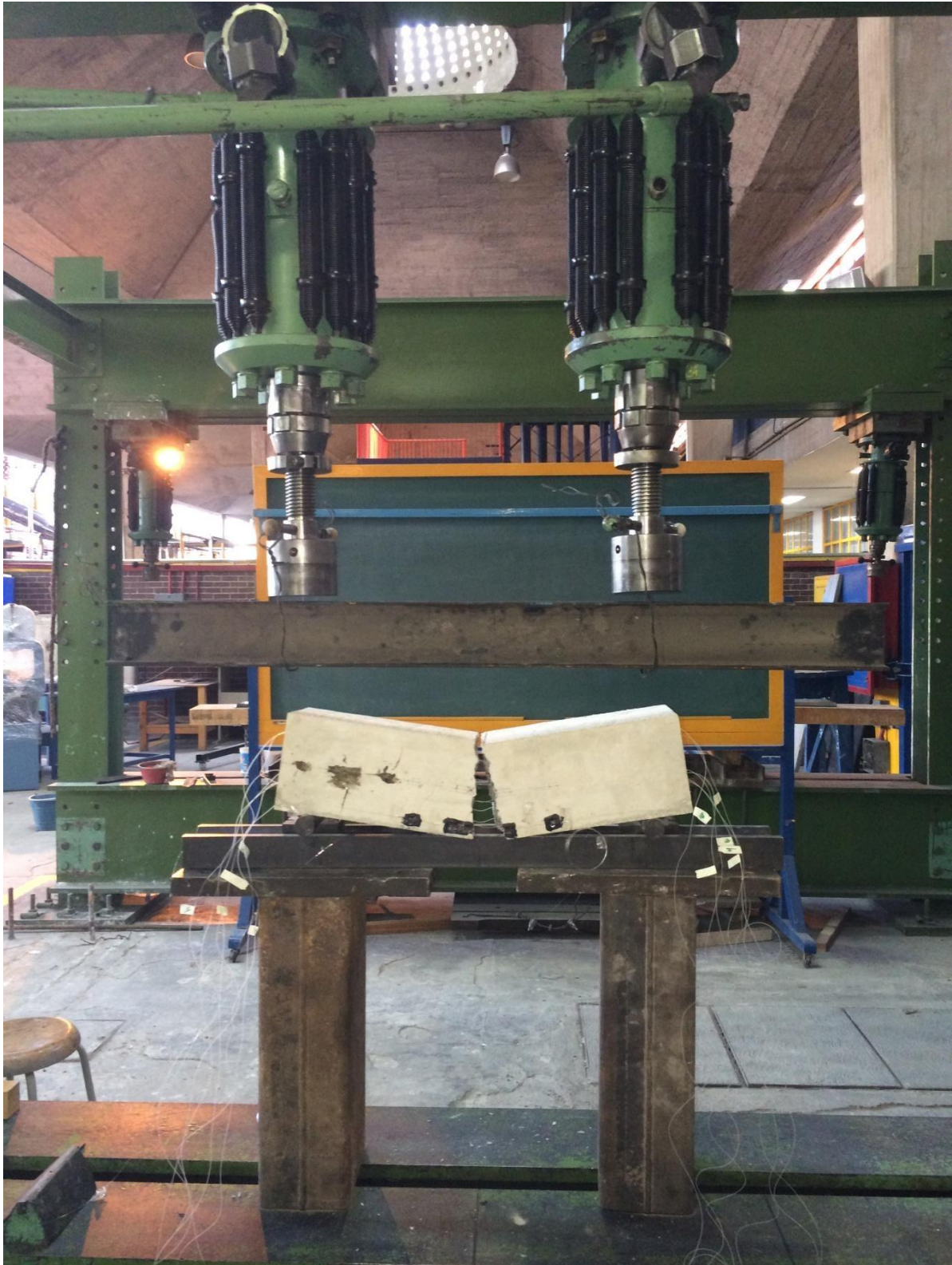
Figura 5.5. Viga de concreto con falla mecánica.
