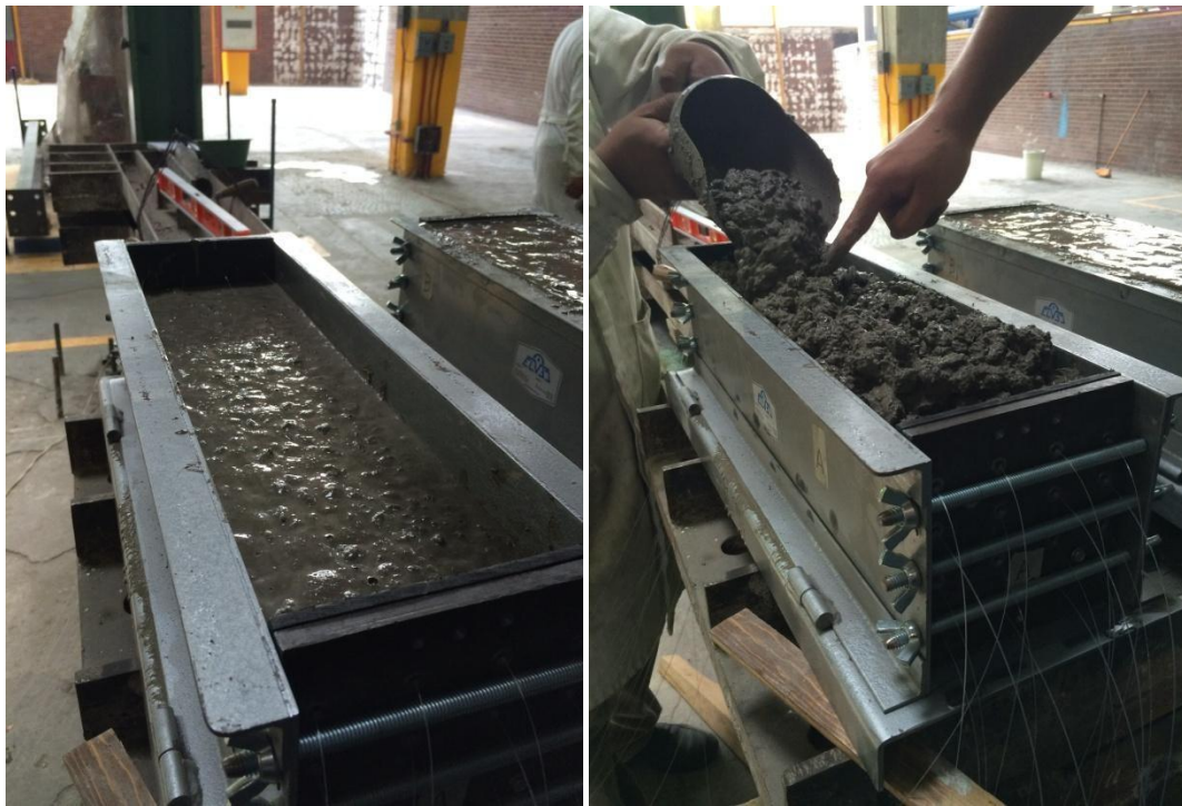
Figura 3.3. Fabricación y llenado del molde #3.
