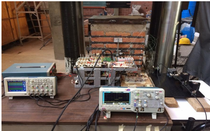
Figura 6.3. Instrumentación de la pila de mampostería con los sistemas de interrogación de arreglos de sensores de fibras ópticas comunes.
