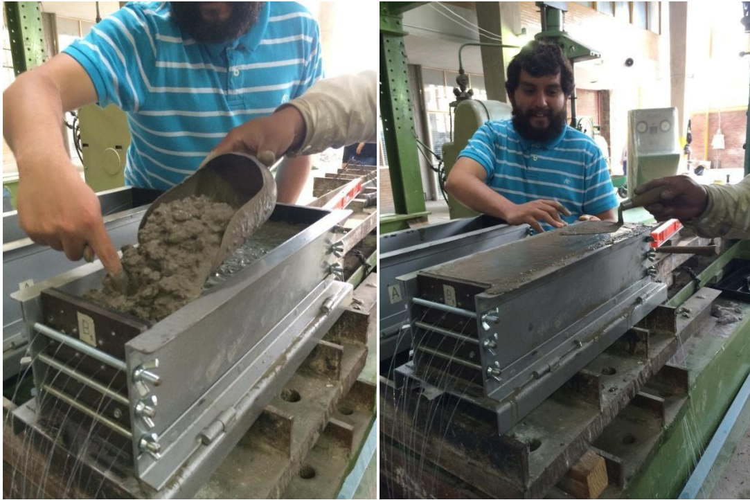
Figura 3.2. Fabricación y llenado de las vigas de concreto con diferentes tipos de fibras ópticas embebidas.
