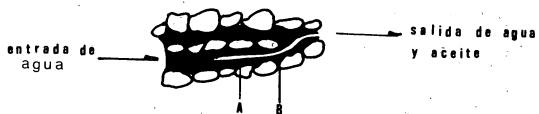
FIG. 4. LA REDUCCION EN LA SATURACION DE ACEITE - PRODUCE UN AUMENTO EN LA TENSION INTERFACIAL QUE CAUSA LA RUPTURA EN LOS PUNTOS A y B. (37)
