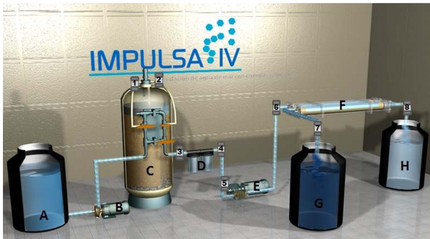
Figura 3. Diagrama general de la planta desaladora y ubicación de sensores.
