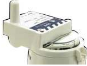
Figura 12. Radio ZigBee (ZED) adaptado en un micromedidor.
