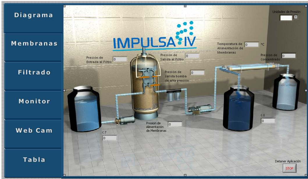
Figura 14. Panel remoto, ventana principal.
