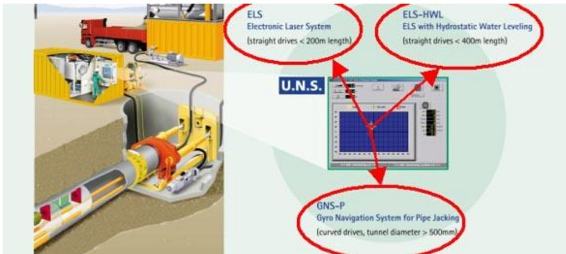
Figura 2.7. Esquema UNS, Herrenknecht. Tomado de <http://www.herrenknecht.com>.
