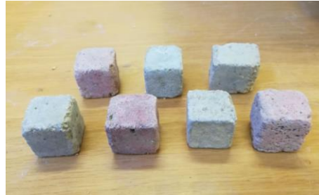
Figura 3. 9 Cubos de concreto
