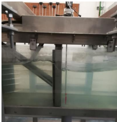
Figura 3. 2 Pala generadora de oleaje
