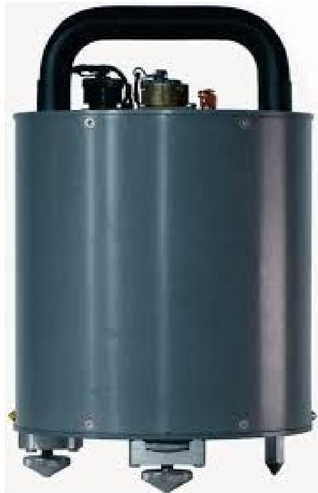
*Figura 9: Sismógrafo de banda ancha Guralp.*
