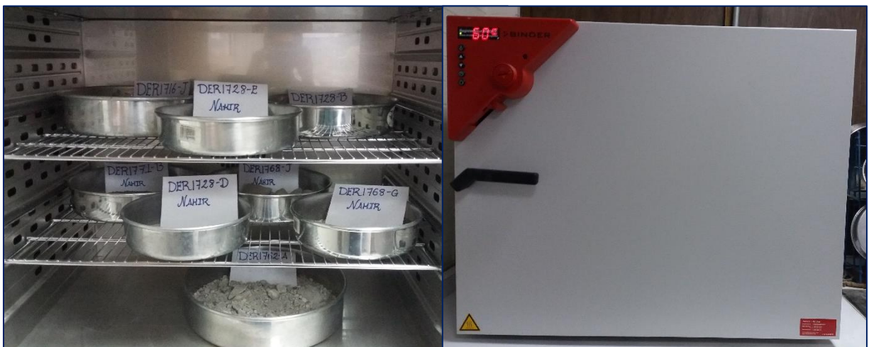
Figura 5.2. Muestras de depósitos de oleadas piroclásticas colocadas en charolas y puestas en horno a 60\text{ }^{\circ}\text{C} . Laboratorio “A” de Sedimentología Volcánica, Instituto de Geofísica, UNAM.
