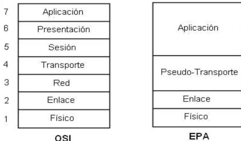
Figura 2.2.3 Comparación Modelo OSI y EPA.
