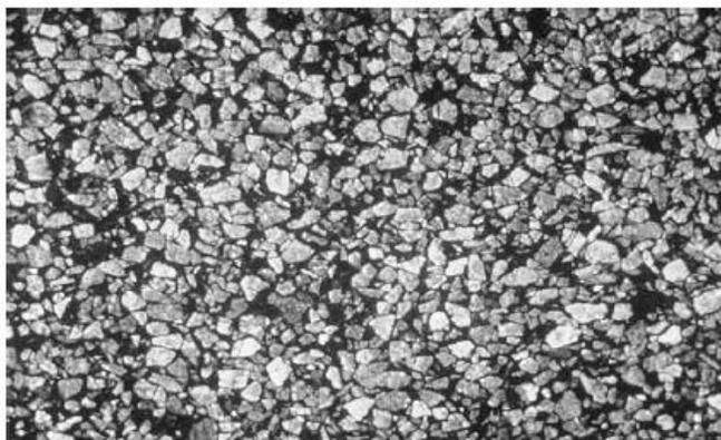
*Se observa el pulimiento de agregados*
