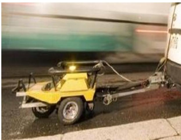
*Se muestra el Mu-Meter para medir la fricción*
