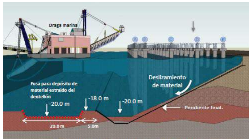
Vista posterior. Dragado de Fosa de depósito.
