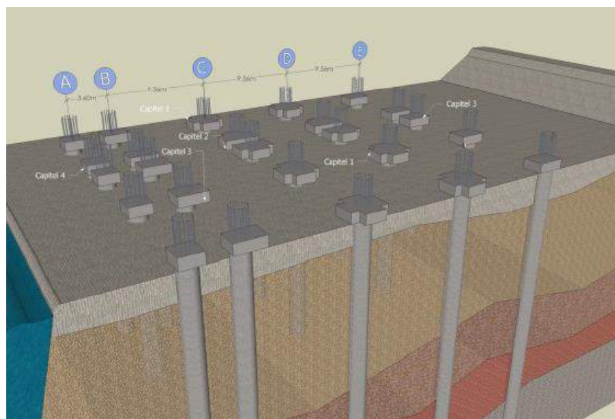
FIGURA 66. Capiteles construidos. “ICA Dirección de Puertos, agua y minería (2014), Documento 1208-Procedimiento Constructivo del muelle, Rev. 02 (28-agosto-2014), p.p. (16).”
