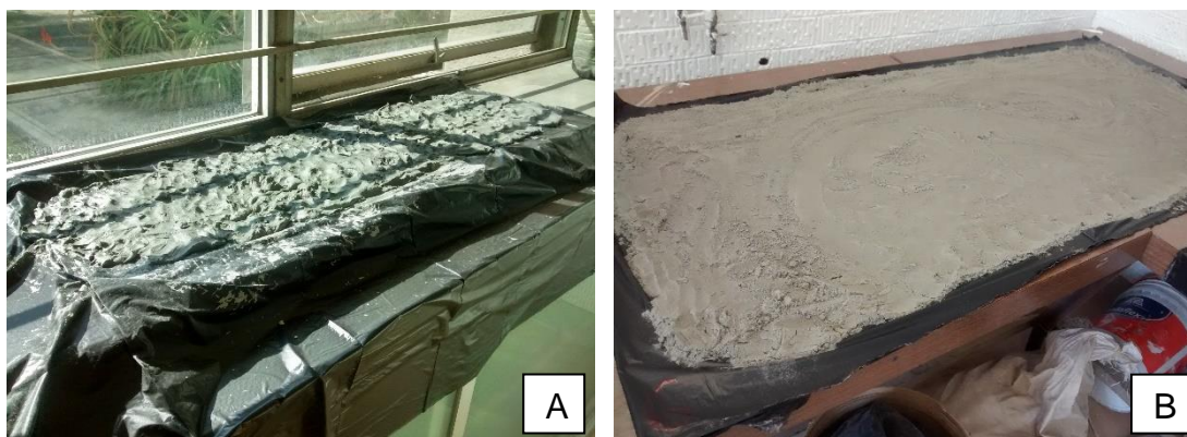
Figura 3.4. Proceso de secado de las muestras. Muestra húmeda (A). Muestra seca (B).
