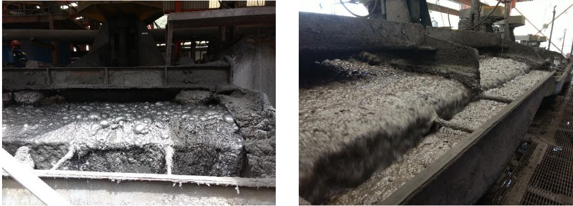
Figura 2.9. Proceso de recuperación de minerales de interés por medio de la técnica de flotación.
