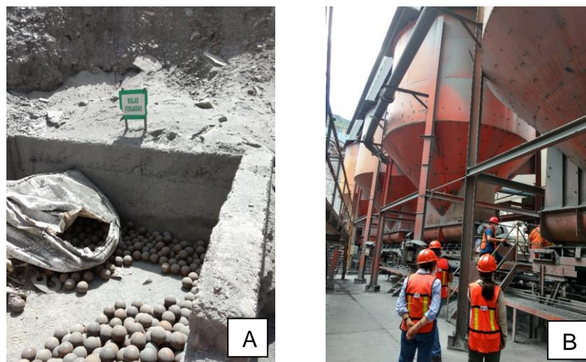
Figura 2.8. Esferas de acero usadas en el proceso de molienda (A) y contenedores del proceso de molienda (B).
