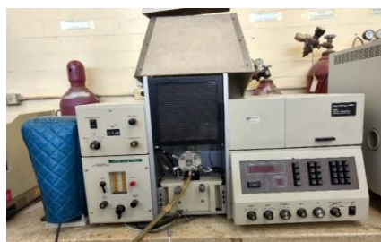
Figura 3.5. Espectrofotómetro de absorción atómica PEKIN-ELMER 2380.
