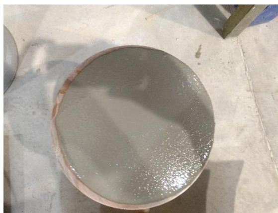
Figura 3.14. Prueba de fluidez en mortero de relleno.
