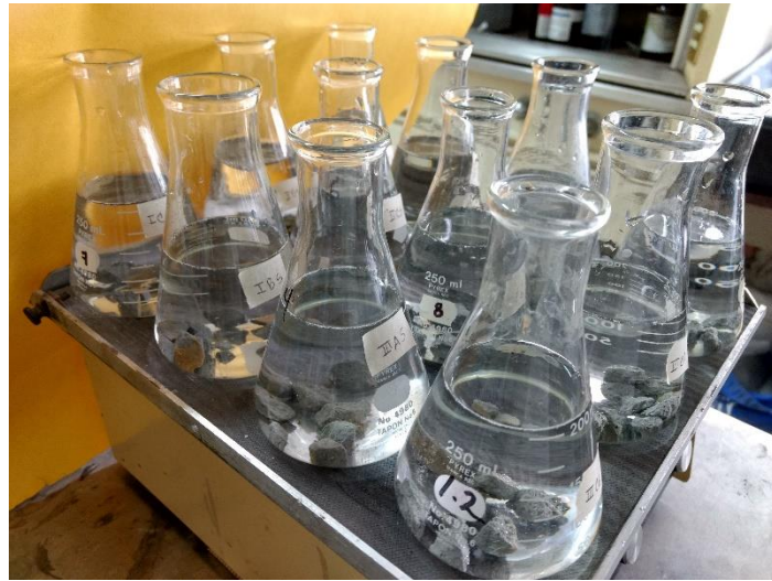
Figura 3.17. Prueba de lixiviación en partículas de especímenes posterior al intemperismo acelerado.
