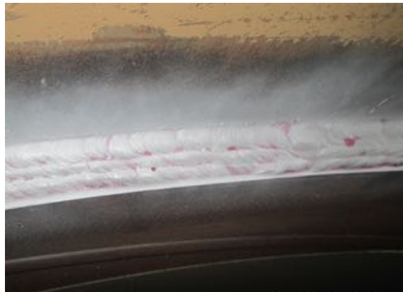
Figura 9. Método de inspección por líquidos penetrantes
