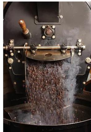
Figura. 31 – Vaciado de café recién tostado e inicio del proceso de enfriamiento de este
