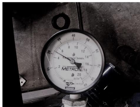
Figura. 58 – Ajuste de presión de succión en la tubería que conecta la etapa dos con la etapa
