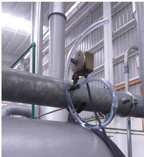
Figura. 24 – Medición de la presión de succión en la tubería de extracción del ciclón de enfriamiento
