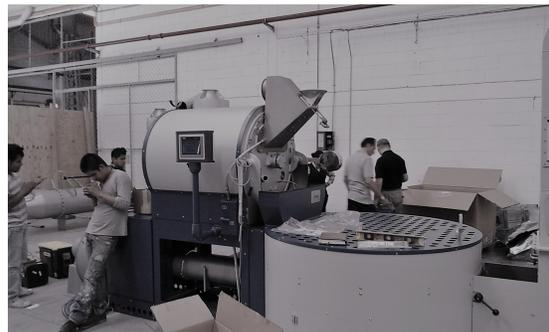
Figura. 67 – Personal de mantenimiento de Restaurantes Toks, desarmó la tubería de salida de aire caliente
