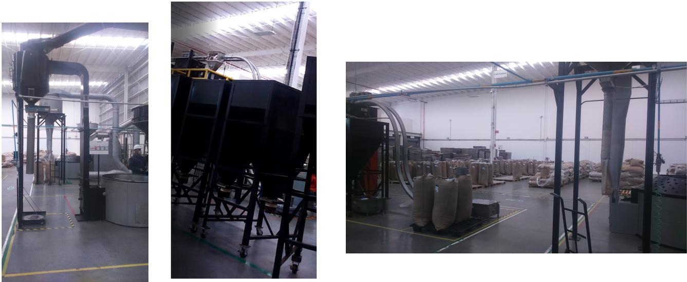
Figura. 36 – Tolva del despedrador, contenedores para el vaciado y lotes para su procesamiento o disposición final
