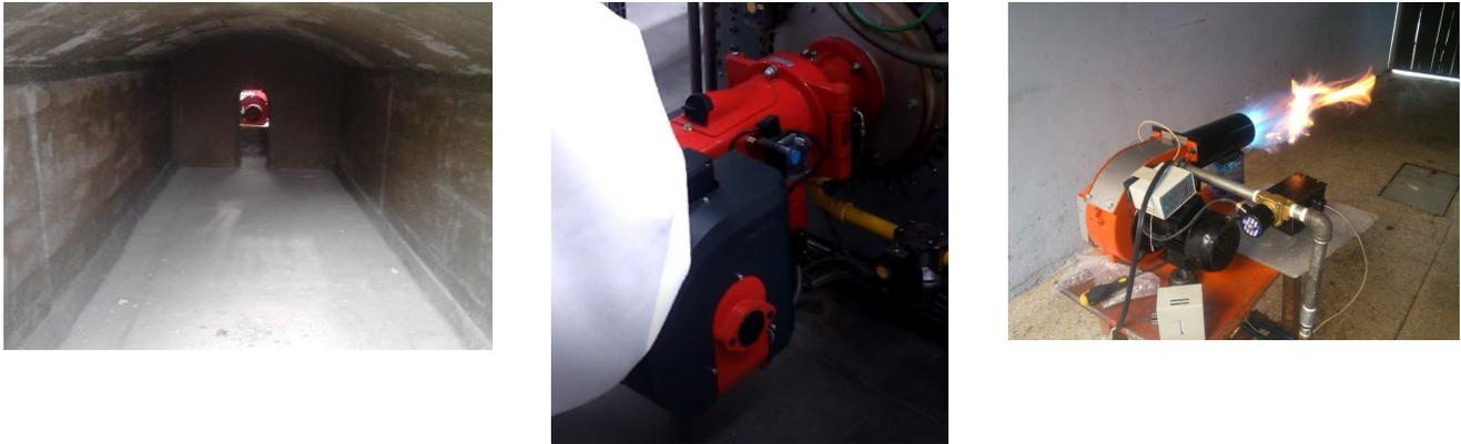
Figura. 26 – Cámara del postquemador, quemador y revisión de flama
