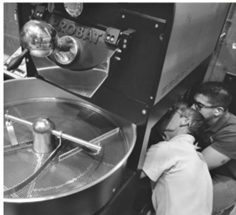
Figura. 38 – Revisando el ajuste de presiones de la flama del quemador
