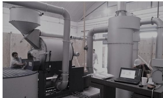
Figura. 57 – Armado de la tubería de extracción después de la limpieza con una disolución de NaOH al 30%
