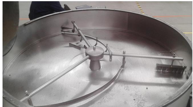
Figura. 33 – Ventilador de extracción y mecanismo agitador
