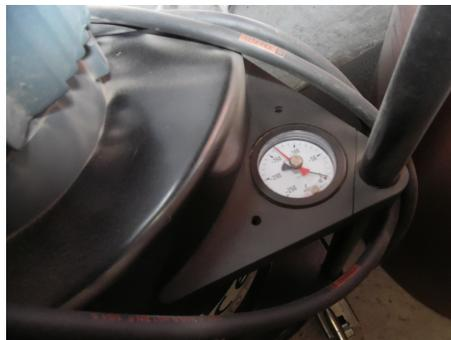
Figura. 16 – Presión manométrica de vacío que genera la aspiradora
