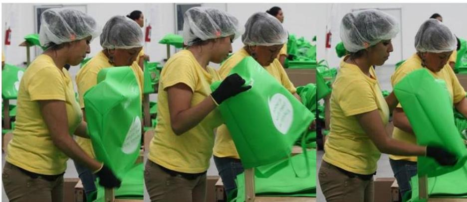
Figura 3. Tiro de la bolsa hacia abajo para formar las esquinas.
