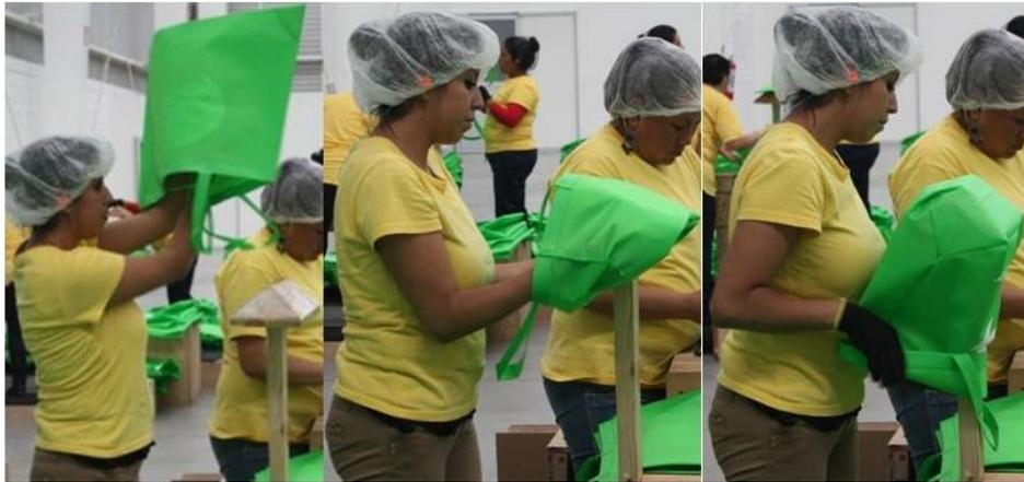
Figura 2. Colocación de la base de la bolsa en el caballete e inicio del volteo.
