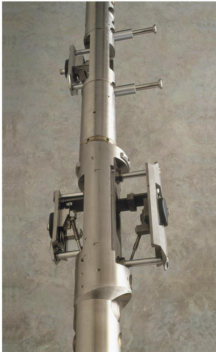
**Figura 4.10:** Estructura de la herramienta MDT con una configuración de pruebas múltiples.
