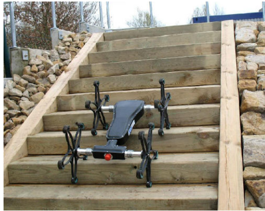
Figura 2.2.7 Imagen de USGUARD subiendo escaleras [7] .
