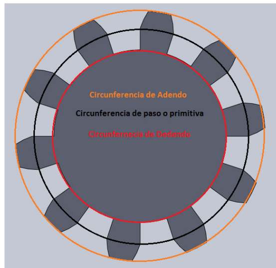
Figura 4.4.3. En esta imagen se muestran los parámetros del engrane, la circunferencia de adendo, dedendo y la circunferencia primitiva.
