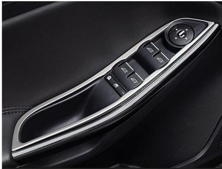
**Figura5. Ensamble botones de control de la ventana y agarradera de copa Ford Focus 2015**
