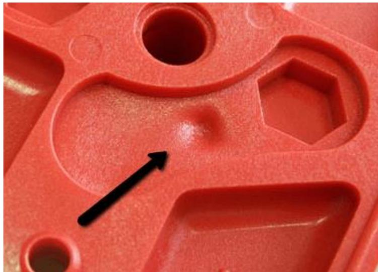
Figura 9. Pieza de plástico con rechupe [6]
