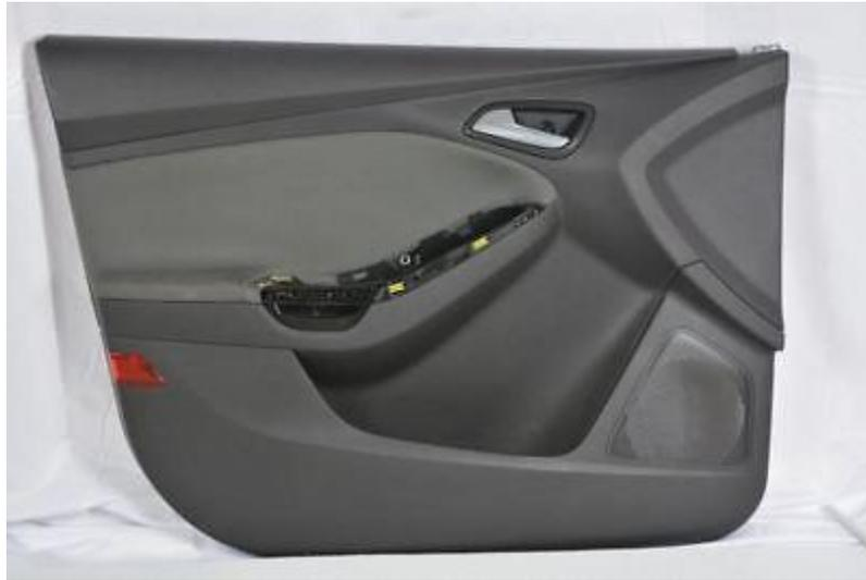
**Figura 4. Interior de la puerta de un Ford Focus 2015**
