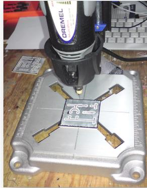
Figura 3.12 Perforaciones en la placa fenólica.
