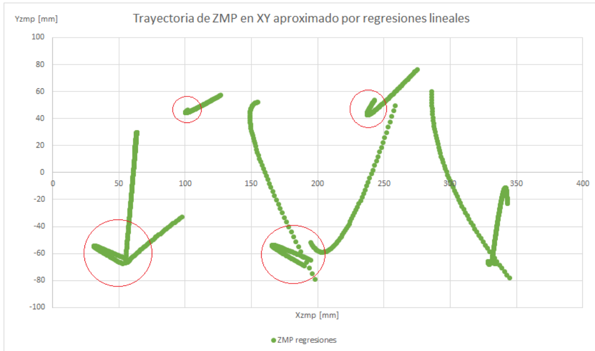
Figura 3.19. ZMP aproximado por regresiones lineales en el plano XY durante la marcha
