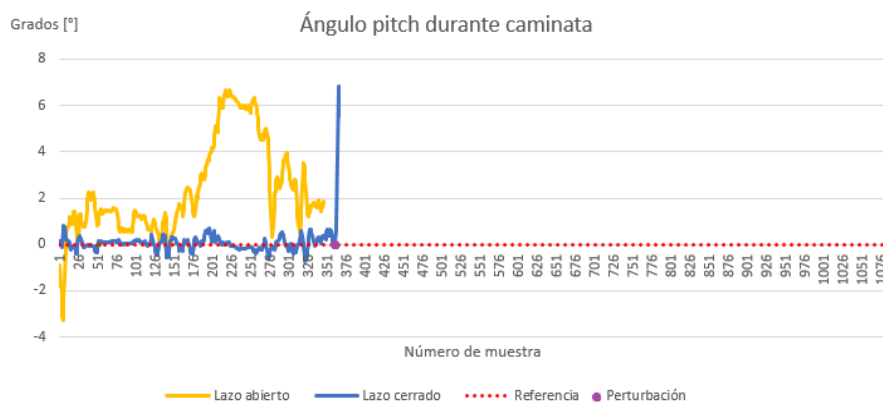
Figura 5.7. Ángulos pitch de la cadera durante la caminata sobre superficie inclinada menos cinco grados en dirección roll
