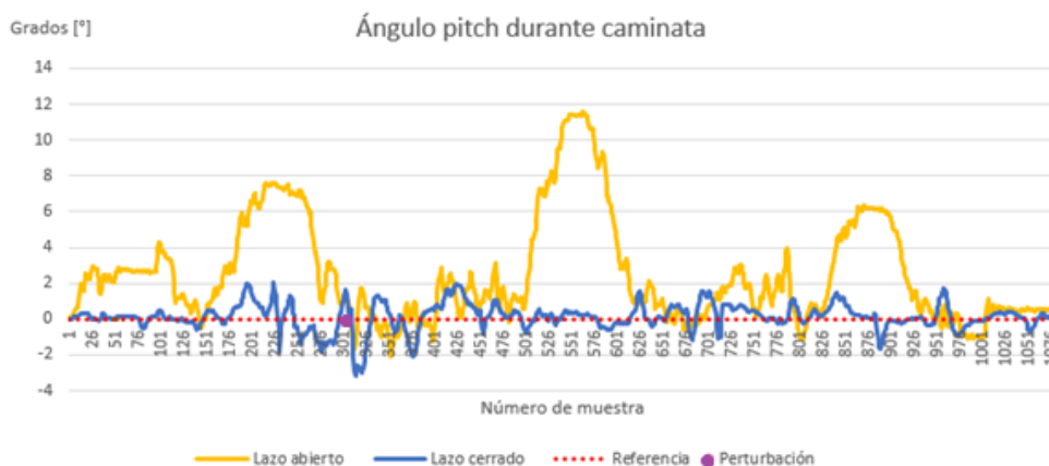
Figura 5.3. Ángulos pitch de la cadera durante la caminata sobre superficie inclinada menos cinco grados en dirección pitch
