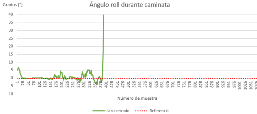
Figura 5.9. Ángulos roll de la cadera durante la caminata sobre superficie inclinada cinco grados en dirección roll
