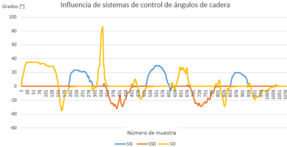
Figura 4.10. Influencia de sistemas de control específicos de cada fase en ángulos de corrección relacionados al control de ángulos pitch y roll durante la marcha
