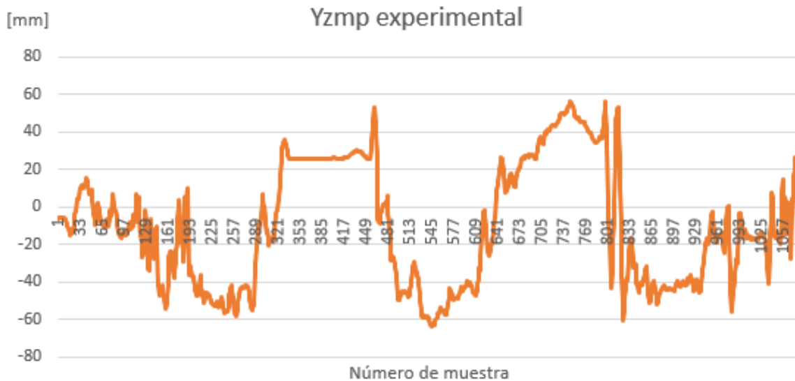
Figura 3.12. Coordenada Y de ZMP experimental durante caminata
