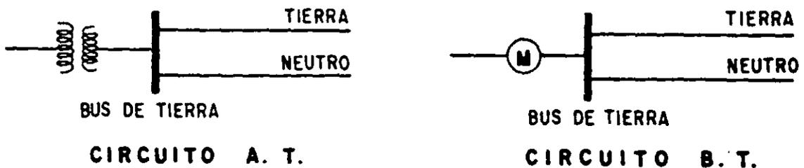
Se recomienda que el voltaje máximo entre neutro y tierra no rebase un volt. Esto es para evitar que los equipos funcionen en forma inadecuada y no reciban información falsa, sobre todo en los equipos computarizados y también para evitar la introducción de ruido eléctrico.
