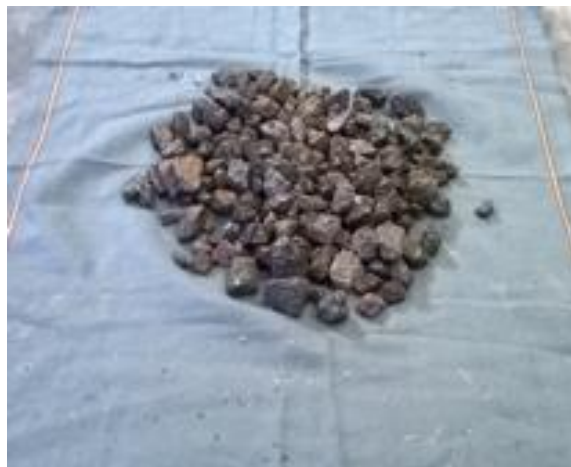
AGREGADO GRUESO MOJADO FOTO DE AUTOR
