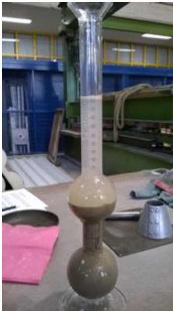
PRUEBA PARA OBTENER LA DENSIDAD DEL AGREGADO FINO. FOTO DE AUTOR
