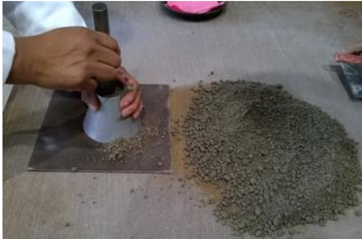
COMPROBACIÓN DEL ESTADO DEL AGREGADO. FOTO DE AUTOR
