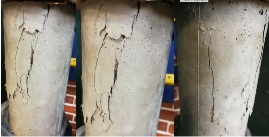
Fallas en cilindros con 0.5% de fibra grande
