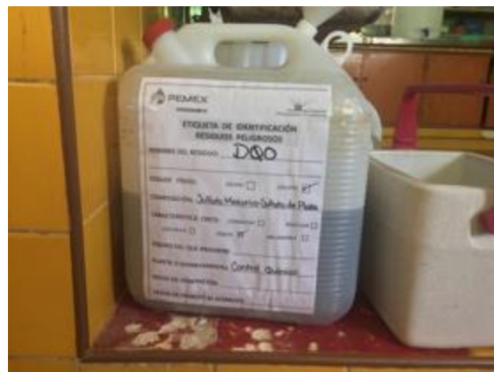
Figura II.2. Etiqueta de identificación de residuo del análisis de la DQO.
