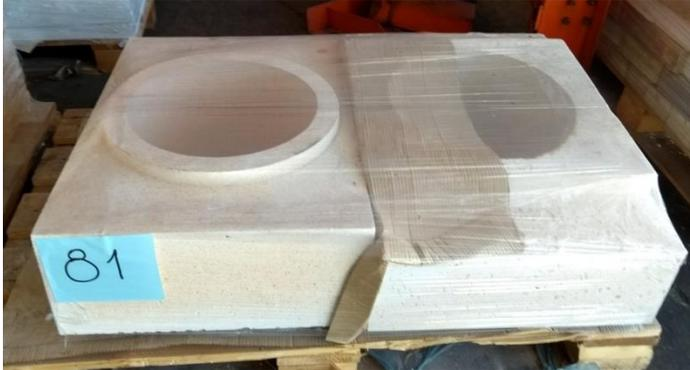
Fig. 27. Ladrillo refractario de mirillas de horno. (Fuente: Fotografía propia)
