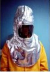
Fig. 33. Equipo de Protección Personal para Trabajos a Altas Temperaturas (Fuente: Logística Comercial BRIGMADI, S.A. DE C.V.)
