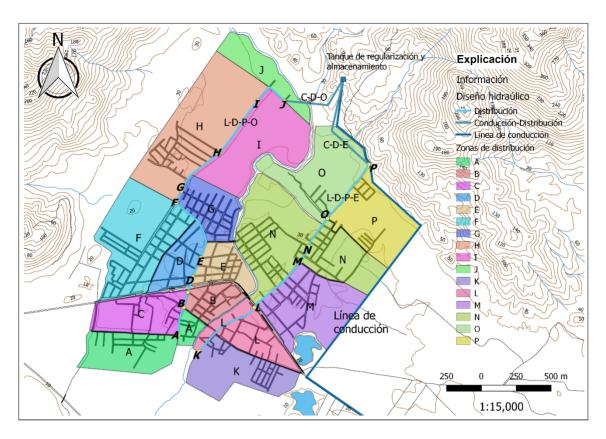
Figura 5.27. Tuberías principales y zonas de distribución.
