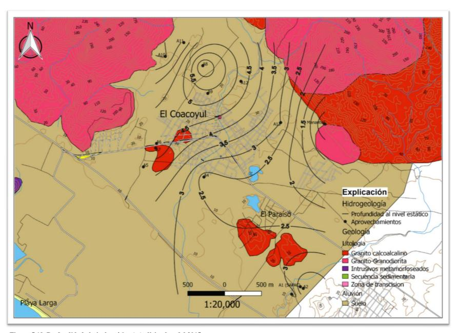
Figura 5.19. Profundidad al nivel estático (m), diciembre del 2015.
