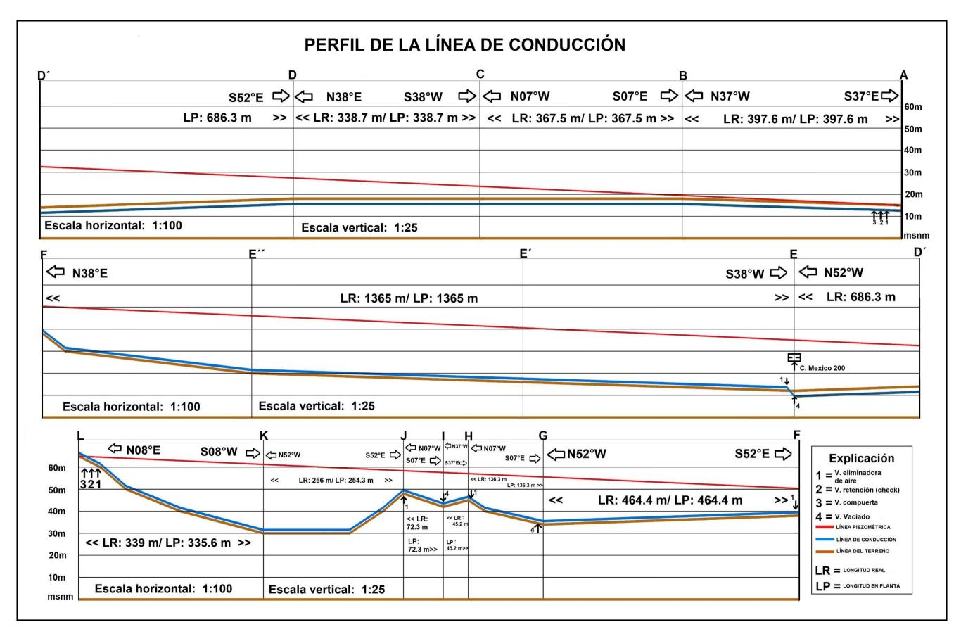
Figura 5.26. Trazo altimétrico de la línea de conducción.
