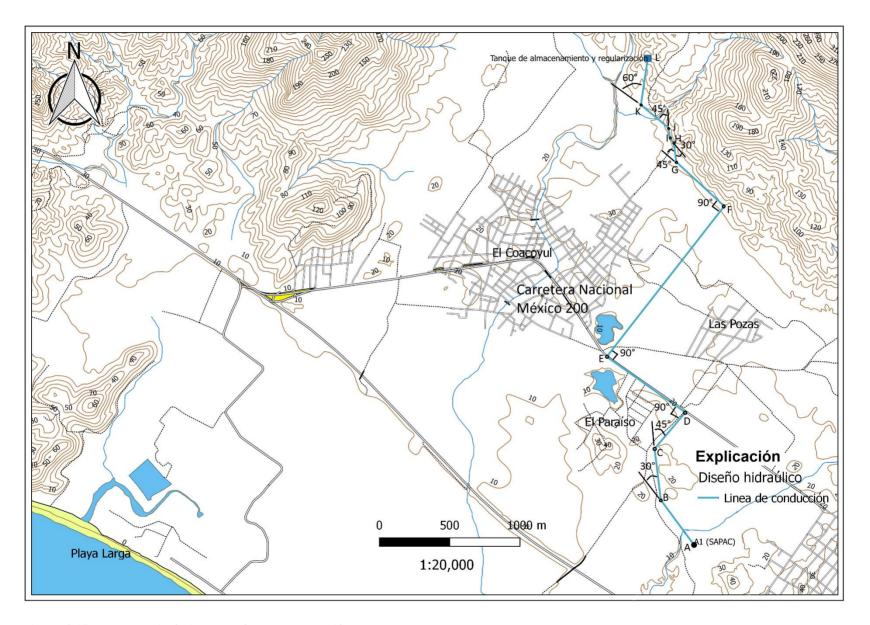
Figura 5.25. Trazo planimétrico de la línea de conducción.
