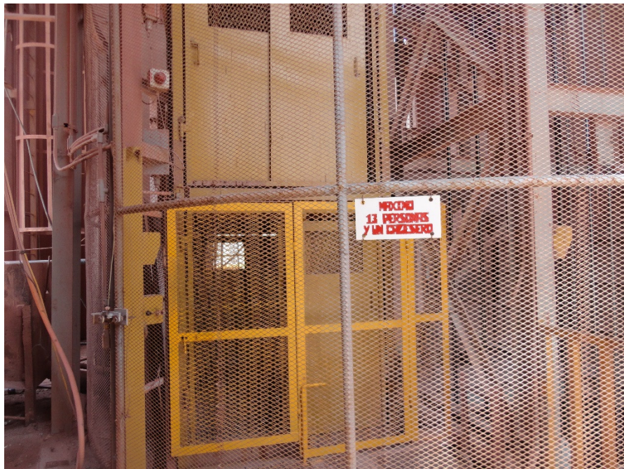
Fotografía 24. La calesa que utilizan para el ingreso a interior mina en donde se transporta el personal con un total de 14 personas por viaje.
