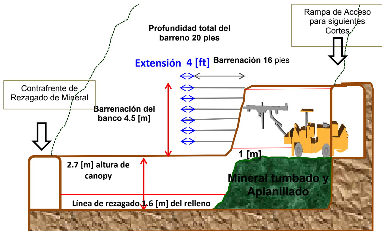
Figura 44. Tumbado sobre carga mostrando todas las líneas de control y la profundidad total de barrenación de 20 pies con barra de extensión.
