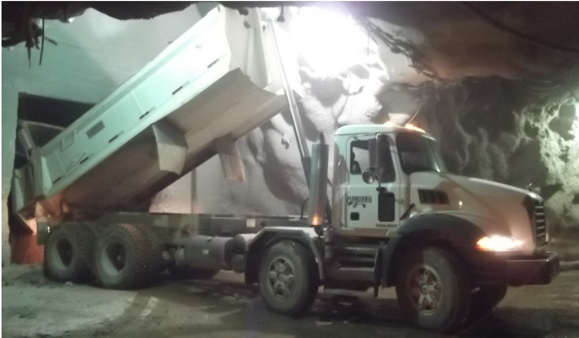
Fotografía 22. Acarreo de mineral por la rampa Guadalupe a la quebradora en el nivel 992.
