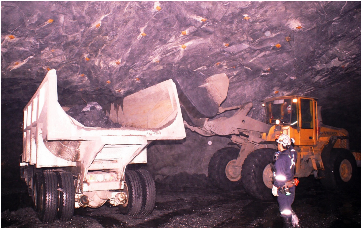
Fotografía 19. Acarreo de mineral con camiones Mack con capacidad de 40 toneladas.
