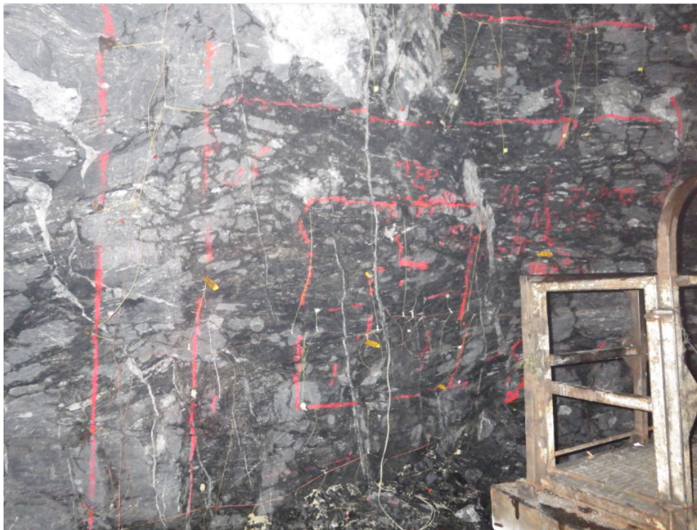
Fotografía 30. Marcaje de la plantilla de barrenación para el desarrollo.
