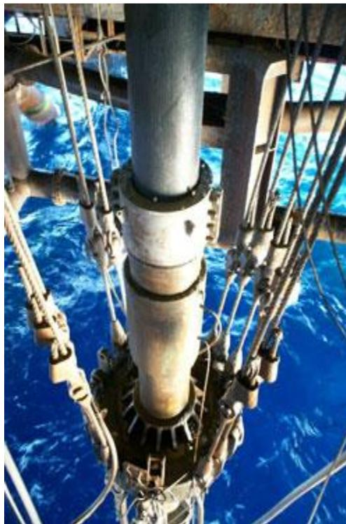
Figura 1.21 Junta Telescópica<sup>31</sup>
