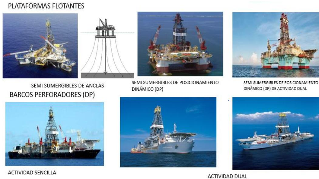
Figura 1.12 Unidades Móviles de Perforación Costa Afuera (Mobile Offshore Drilling Unit)<sup>16</sup>
