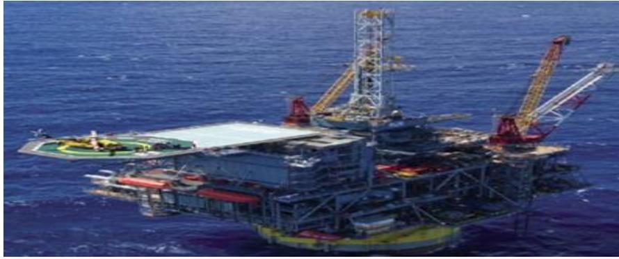
Figura 1.4 Equipo flotante tipo SPAR<sup>5</sup>
