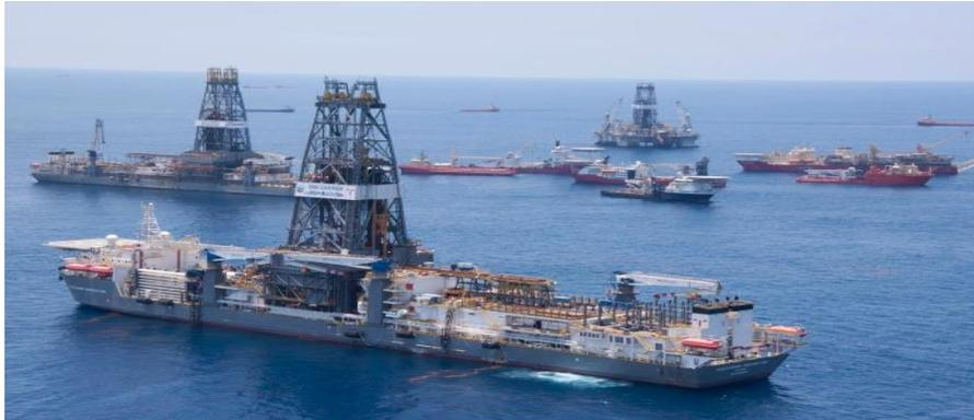
Figura 1.13 Barco Perforador<sup>18</sup>
