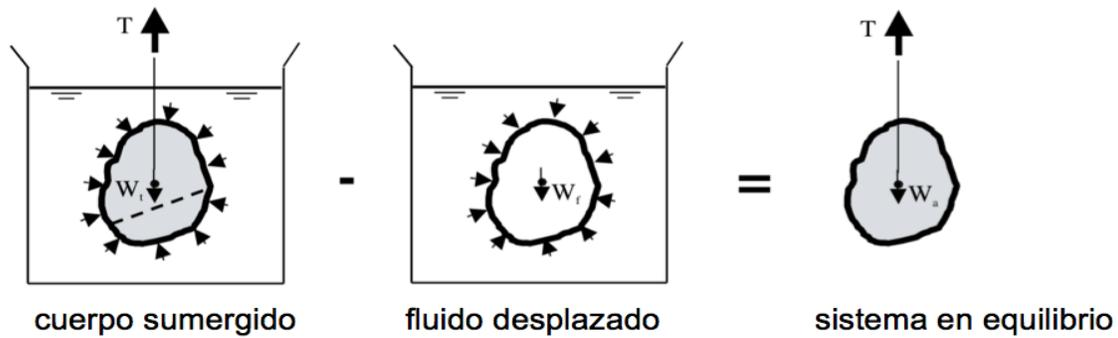
Figura 2.4 Ley de Arquímedes por superposición<sup>77</sup>
