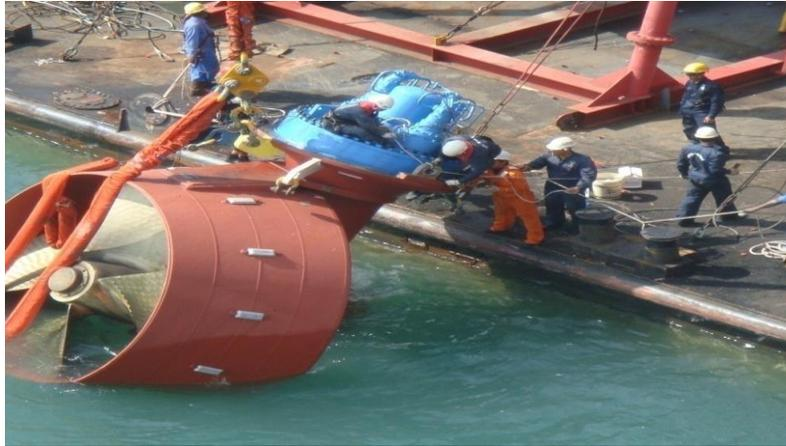
Figura 1.10 Propulsor o Thrusters en ingles<sup>11</sup>
