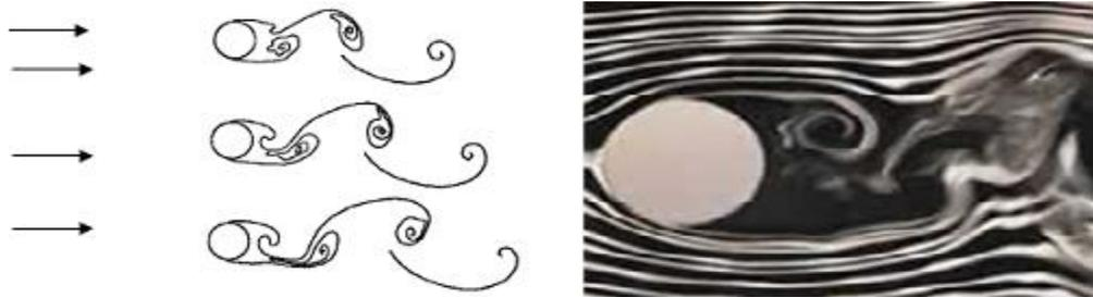
Figura 1.38 Vibraciones inducidas por vórtices<sup>69</sup>
