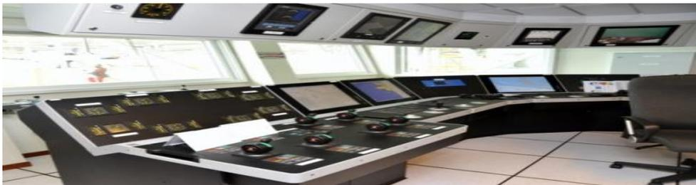
Figura 1.8 Cuarto de Control de posicionamiento dinámico del equipo flotante<sup>9</sup>
