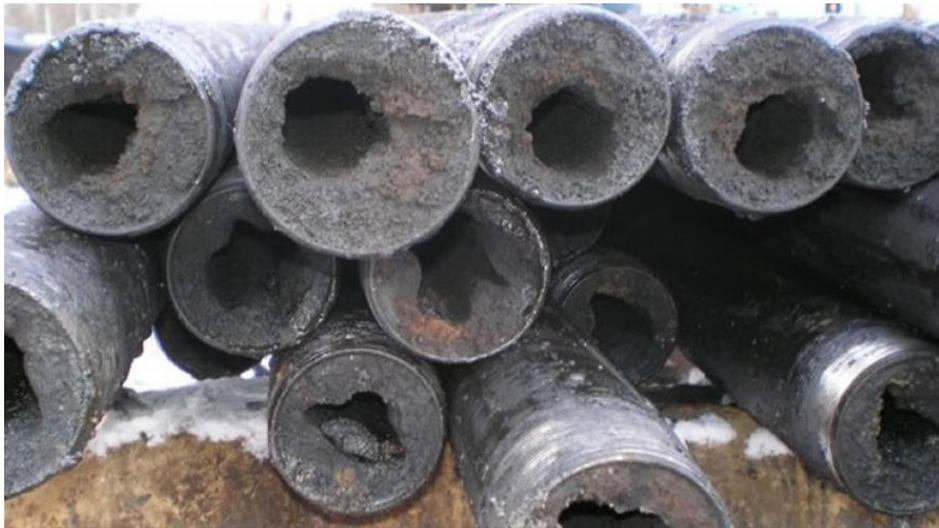
Figura 11. Taponamiento de asfaltenos en tuberías
