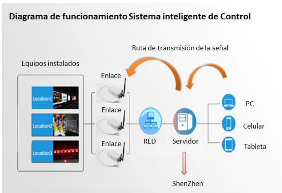
Figura 32. Diagrama de funcionamiento de sistema inteligente de control de sistemas LED.
