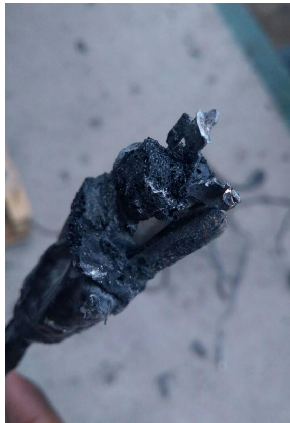
Figura 2. Clavija de alimentación para mobiliario dañada en conato de incendio.
