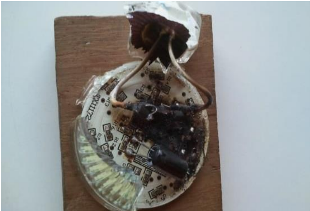
Figura 8. Ejemplo de Lámpara LED tipo MR16 con driver integrado dañada.
